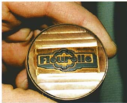
Uralan entwickelt und fertigt auch seine Kupferelektroden mit Hilfe von Solidworks und Camworks selbst.
